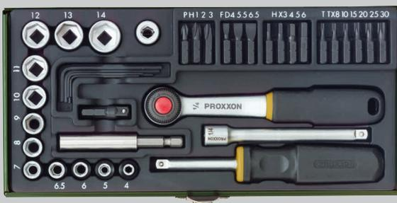
**Coffret pour la fine mécanique avec cliquet compact 1/4" et jeu de douilles avec embouts magnétiques puissants. 32 pièces.**
