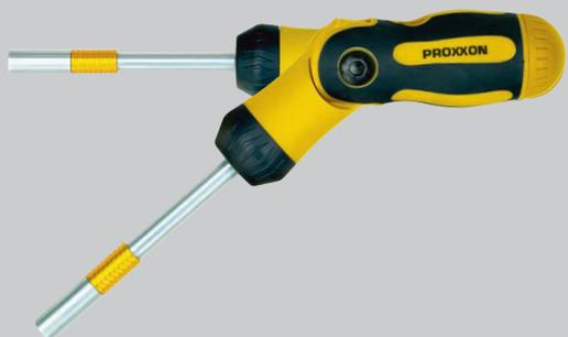
Verrouillage de la poignée en appuyant sur un bouton dans les liaisons normales et angulaires. Le passage de la droite à la rotation anti-horaire se fait en tournant la bague de sélection. A la position centrale, la fonction d'encliquetage est éliminée. Système autolock: Les embouts sont fixés automatiquement lors de l'inversion par ressort et aimant. Pousser l'éjecteur en arrière pour supprimer.
