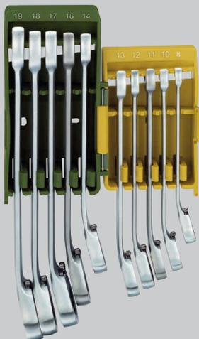
Avec fonction de cliquet sur le côté de l'anneau et mécanisme inverseur droite-gauche. Pour gagner du temps en travaillant sans repositionnement. Idéal pour le vissage sur des surfaces planes grâce à l'anneau incliné de 15°. Clipsée dans un support pliage fonctionnel, chaque clé a sa place fixe. Le compagnon idéal du chantier. Avec option supplémentaire de montage mural dans l'atelier. Tailles de clés bien lisibles. Rangement pour toujours!
