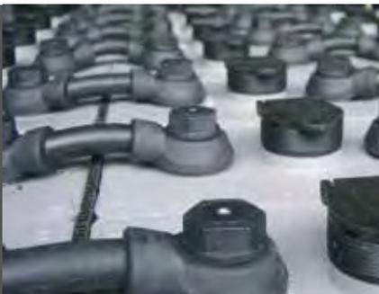
**"Version-S":** les éléments sont liés par des connexions souples vissées (avantage: antivibrations, facile à remplacer, ...)
