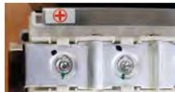
Le LiFePO4 est seulement utilisé dans les applications industrielles et logistiques. C'est important de comprendre que cette technologie ne prend pas feu ou n'expose pas, même si la batterie est défectueuse. C'est entièrement protégé. Les cellules sont assemblées en modules avec rails soudés au laser. Cette connexion réduit la résistance interne et réduit le risque de mauvaises connexions.
