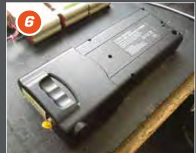
6 Fermer le boîtier et recharger la nouvelle batterie
