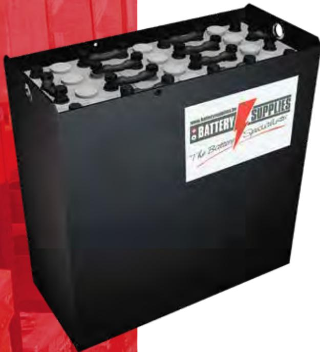
La série maintenance minimum peut avoir un intervalle de remplissage allant jusqu'à 13 semaines. Cela est possible grâce à l'alliage à faible teneur d'antimoine de la plaque en combinaison avec l'espace accru dans le haut de la cellule.
