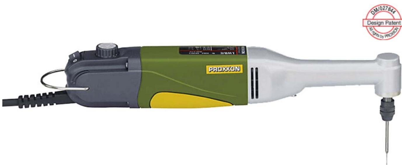
Convient aussi pour le tronçonnage en angle droit. Moteur spécial DC équilibré, puissant, silencieux et durable. Réglage progressif du régime (électronique à onde pleine). Boîtier central en POLYAMIDE renforcé de fibre de verre. Rangement sûr dans une attrayante mallette robuste en plastique de qualité. Avec pinces de serrage MICROMOT en acier (1 de chaque: 1 - 1,5 - 2 - 2,4 - 3 et 3,2 mm).
